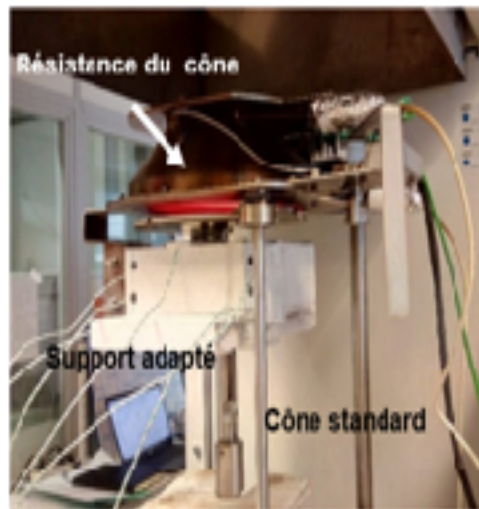
Exposition de l'outil sous un éclairage énergétique généralisé par la résistance chauffante du cône calorimètre
