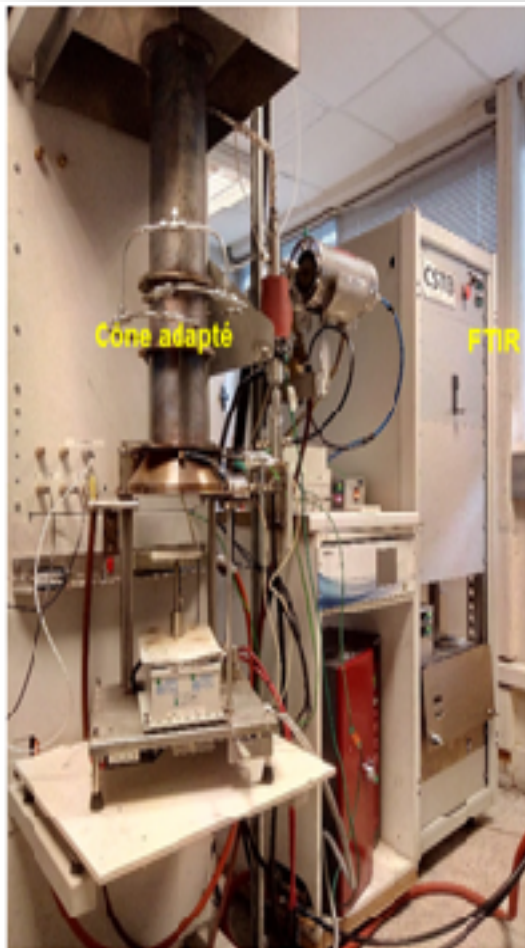
Dispositifs expérimentaux associés au cône calorimètre ; adaptation avec FTIR et ELP
