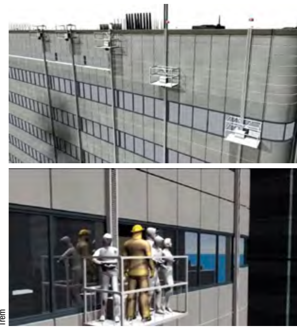
La société Trem développe une navette de sauvetage autopropulsée fixée facilement à un rail installé sur le mur extérieur des édifices.
